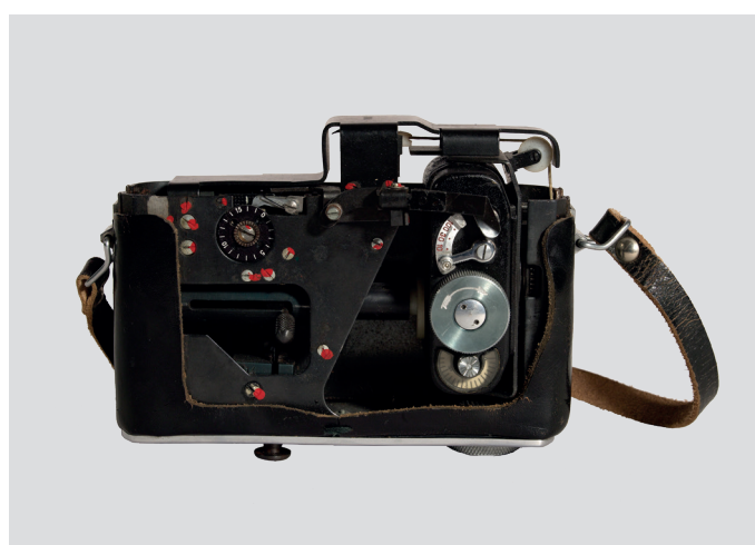
Appareil photo F-21 « Ajax » caché à l'intérieur d'un autre appareil photo pour prise de vue latérale clandestine (nom de code « UKOS »). F-21 "Ajax" camera hidden inside another camera for clandestine lateral shooting (code name "UKOS").
