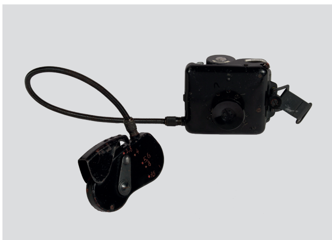
LA PREMIÈRE PIÈCE DE LA COLLECTION DE STÉPHANIE M. Appareil photo KMZ F-21 « Ajax » avec dispositif cache-bouton et déclenchement manuel. Produit à partir de 1951. L'objectif de l'appareil photo est masqué par le bouton qui s'ouvre transitoirement pour la prise de vue. KMZ F-21 "Ajax" camera with button cover and manual release. Produced from 1951. The camera lens is hidden by the button which opens temporarily for shooting.
