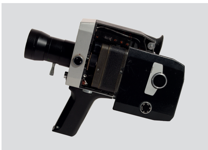
Camera KMZ « Quartz » 1x8 S-2 modifiée par le KGB (URSS), avec un appareil photo F-22 « NAILON » caché à l'intérieur et permettant la prise de photo clandestine à un angle de 90°. Movie camera KMZ "Quartz" 1x8 S-2 modified by the KGB (USSR), with camera F-22 "NAILON" hidden inside and allowing the taking of clandestine photos at an angle of 90°.
